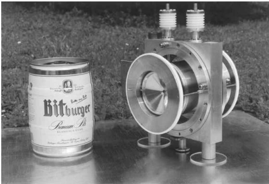
Abbildung 2.3: Die Paulfalle für ISOLTRAP. Schnittbild und Fotografie.
