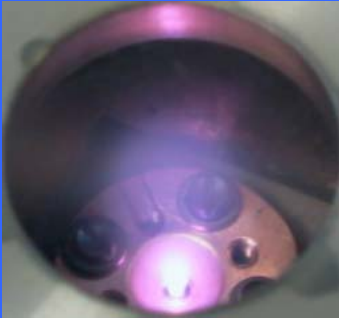
Plasmaquelle zur Erzeugung metastabiler He-Atome
